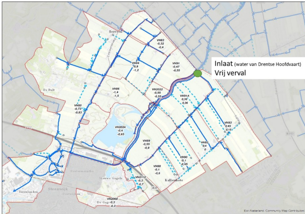
Figuur 9 Overzicht inlaatmogelijkheden
